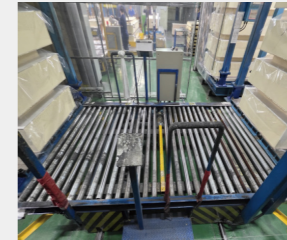
대차 롤러 사이 발 끼임으로 인한 골절 위험
